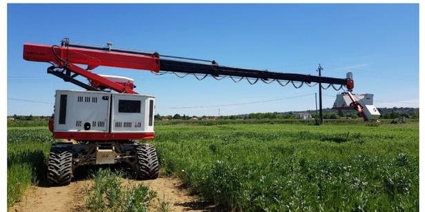
Ce robot est composé : (i) d'un porteur à chenilles, (ii) d'un bras télescopique pouvant atteindre 12 mètres et (iii) d'une nacelle portant un dispositif d'éclairage (flash) pour uniformiser les conditions d'acquisition des images ainsi que différents capteurs :
